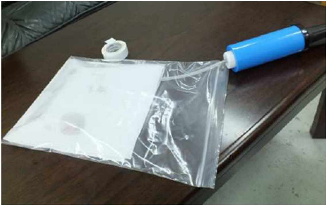
③手動ポンプによる空気の吸引 写真のビニールテープは酸素を遮断するため穴のシール用
