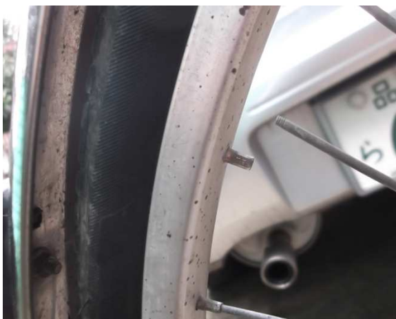
図1 折れたスポーク ニップルの先端部でネジ切れている。
