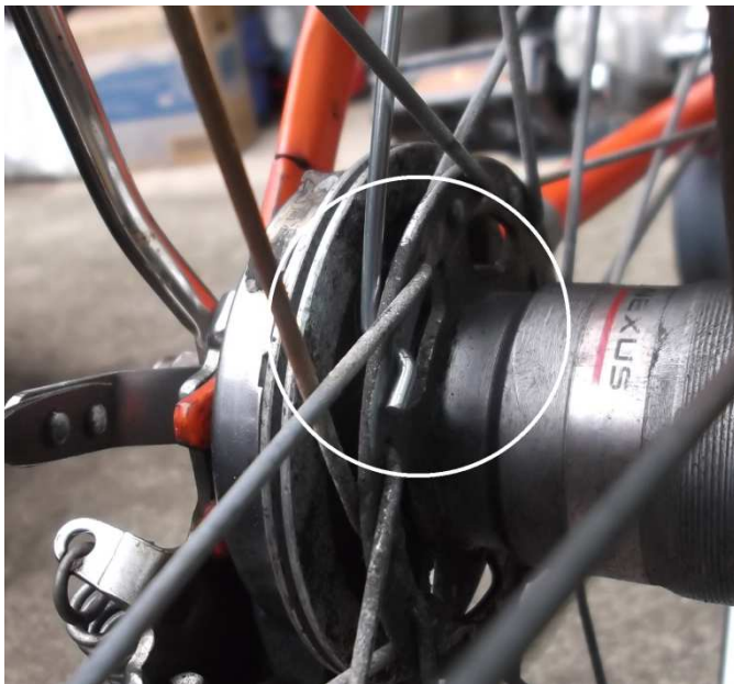
図4 交換したスポーク ステンレス製なのでちょっと目立ちます。
