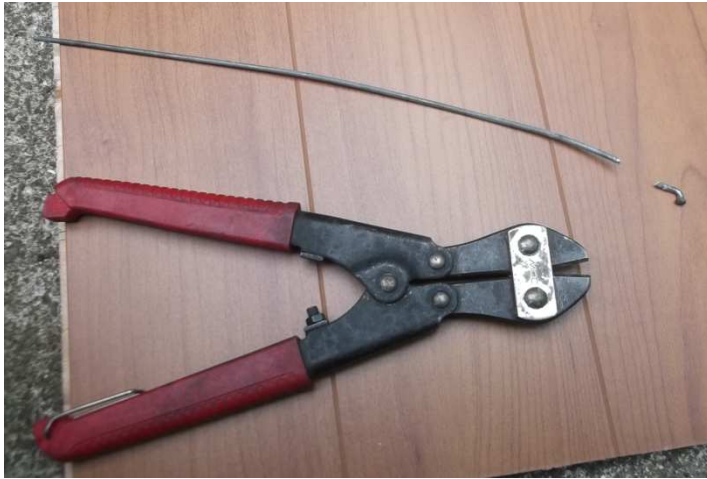
図3 切断された折れたスポークと小型ワイヤーカッター
